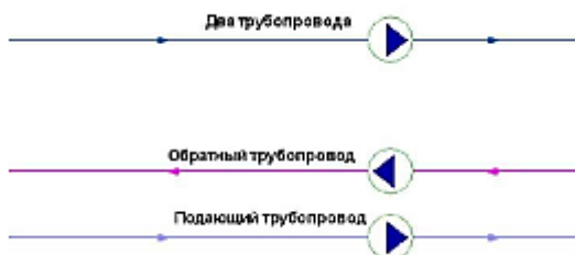
Рисунок29 - Однолинейное изображение (вверху) и внутреннее представление (внизу) сети с насосными станциями
